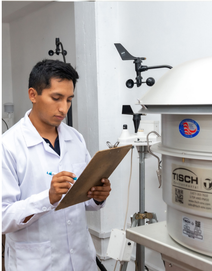
Analista del LANAMB verificando la operatividad de muestreadores de aire para PM10 y PM2.5
